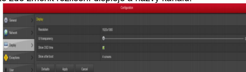
**Resolution (Rozlišení):** Rozlišení video výstupu NVR. Volitelné rozlišení: 1024 × 768, 1280 × 720, 1280 × 1024, 1920 × 1080. Výchozí rozlišení je 1280 × 1024. Platí pouze po opětovném spuštění NVR.
