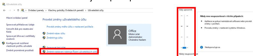
Active X nelze načíst. Upravte úroveň zabezpečení a nastavení brány firewall na nejnižší hodnotu a provedte úpravu IE: Možnost Internet Tool – Vlastní úroveň – ActiveX – povolte všechny možnosti ActiveX a klepněte na tlačítko „OK“. Služba ActiveX bude automaticky stažena a nainstalována.
