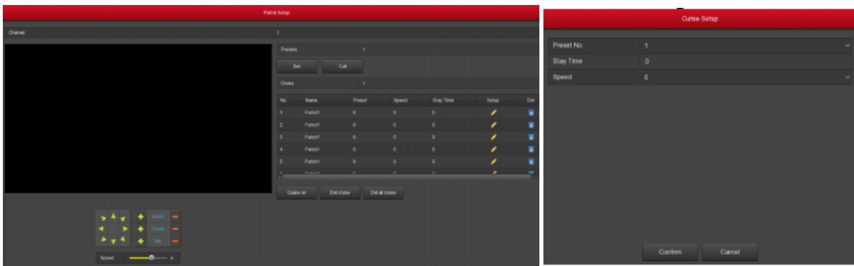
**Nastavení předvoleb:** V rozhraní patrol setup si pomocí směru tlačítek PTZ namapujete trasu pohybu na požadované místo pro jednotlivé kanály. Klepnutím na tlačítko předvolby pod tlačítkem "Nast." ("Set") dokončíte nastavení přednastavených bodů.
