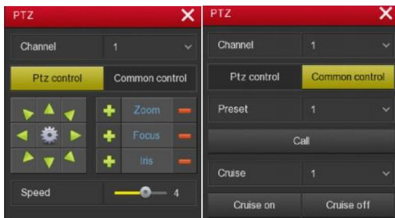
Ovládací rozhraní PTZ je rozděleno na ovládací prvek PTZ a obecné ovládání. PTZ řídící rozhraní slouží k nastavení směru PTZ, rychlosti a přiblížení objektivu, nastavení zaostření clony. V řídícím rozhraní PTZ můžete přepínat další kanály, nastavit rychlosť pohybu PTZ, také můžete řídit směr pohybu.
